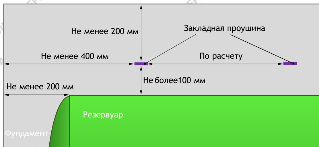
Рис. 12. Закладка проушин на фундаментной плите (вид сверху)
