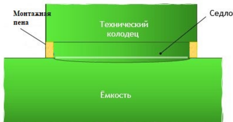
Рис. 17. Установка технического колодца
